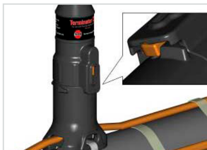
13. Монтаж набора завершен. Убедитесь в том, что фиксатор защелкнулся.
